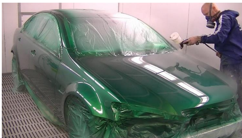
Slika 25. Proces farbanja u namjenskoj komori 12
